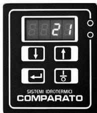
Il display visualizza la temperatura rilevata dalla sonda, la valvola è in funzione. Nel caso di mancata alimentazione, alla riaccensione non occorre l'intervento dell'operatore; la valvola riprende a lavorare con le ultime impostazioni programmate. Per spegnere premere il tasto "ON/OFF", apparirà la scritta "OFF" se l'apparecchiatura resta alimentata. In "OFF" la valvola si posiziona nella condizione opposta a quella programmata per l'attraversamento del set-point.
