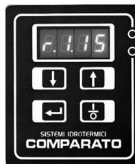
Nel momento in cui si alimenta l'apparecchiatura viene indicata sul display, per alcuni secondi, la versione di software installata.
