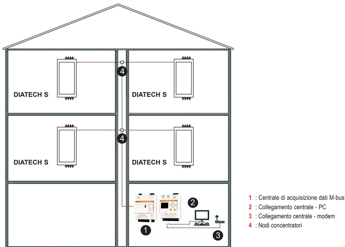
Il sistema **M-bus** rappresenta un modo di comunicazione, via cavo, tra le unità periferiche di contabilizzazione, ed una centralina remota verso la quale convergono i dati di consumo rilevati dalle singole unità periferiche.
