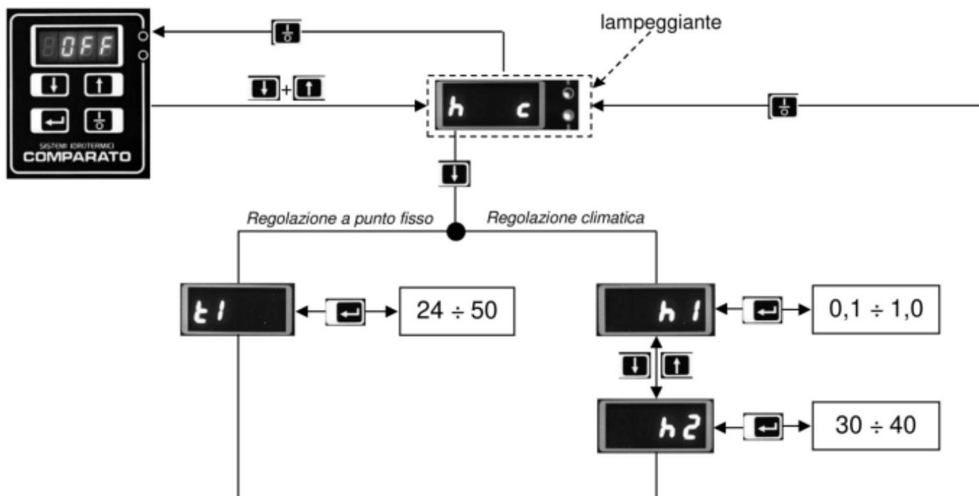
Per accedere al menù, quando il display visualizza la scritta "OFF" premere contemporaneamente i pulsanti "A" e "B". Il display visualizza la scritta "h c" lampeggiante. Premere il tasto "A" per accedere al menù di programmazione riscaldamento. Il menù mostra parametri differenti in funzione del tipo di regolazione selezionata. I tasti "A" e "B" scorrono il menù principale. Il tasto "C" entra nei sottomenù.
