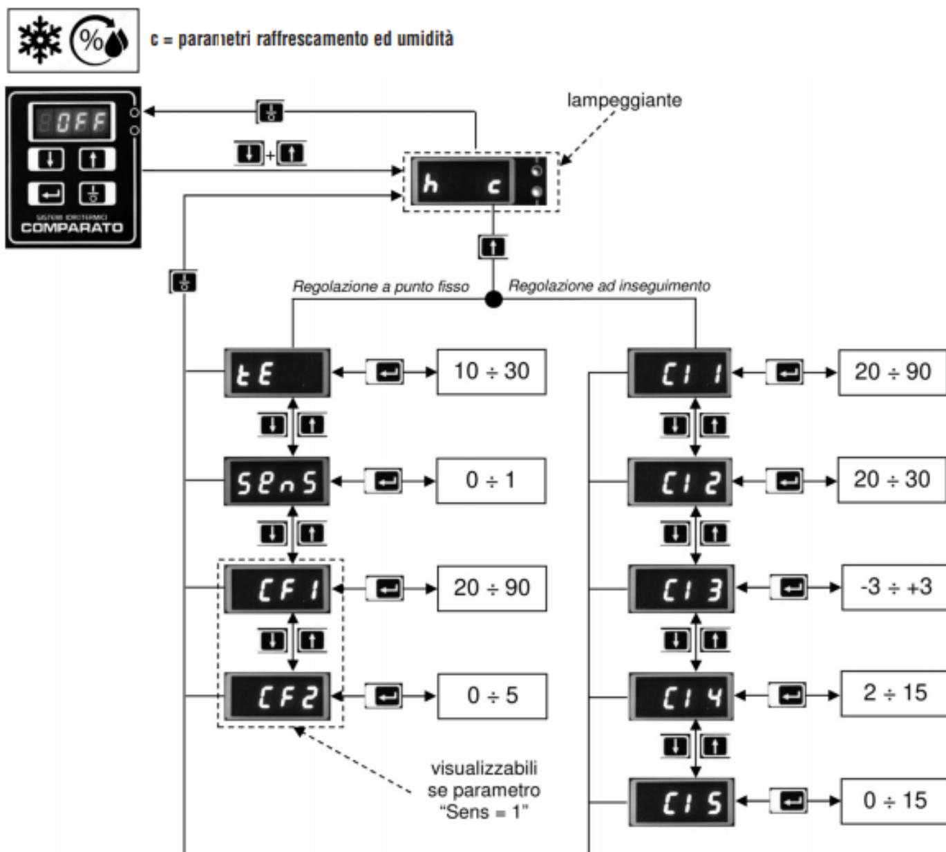
Per accedere al menù, quando il display visualizza la scritta "OFF" premere contemporaneamente i pulsanti "A" e "B". Il display visualizza la scritta "h c" lampeggiante. Premere il tasto "B" per accedere al menù di programmazione raffreddamento ed umidità. Il menù mostra parametri differenti in funzione del tipo di regolazione selezionata. I tasti "A" e "B" scorrono il menù principale. Il tasto "C" entra nei sottomenù.
