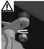
Per i modelli **DIAMANT PRO** e **DIAMANT 2000** il dado di fissaggio al corpo valvola **non deve essere serrato a più di 4 Nm**
