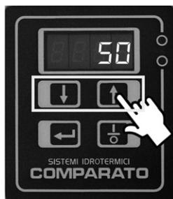
Quando il display visualizza la temperatura di mandata dell'acqua calda sanitaria premere il pulsante A – FRECCIA SU o B – FRECCIA GIU': il valore di setpoint lampeggia.
