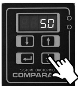
Premere il tasto D-ON/OFF: sul display compare la temperatura istantaneamente rilevata dalla sonda posta sulla tubazione di mandata.
