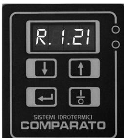
Immediatamente a display compare la versione software installata (nell'immagine a lato è riportato un esempio).
