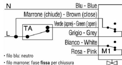
**Più servocomandi possono essere azionati da un singolo comando elettrico.** L'alimentazione con fase al filo marrone determina la chiusura della valvola (autochiusura elettrica), mentre alimentando anche il filo verde ne consegue l'apertura.
