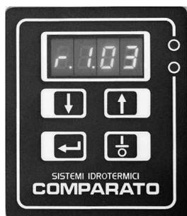
1. Nel momento in cui si alimenta l'apparecchiatura, viene indicata sul display, per alcuni secondi, la versione del software installata.
