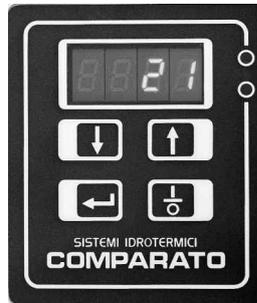
3. Il display visualizza la temperatura rilevata dalla sonda, il modulo è in funzione. Nel caso di mancanza di alimentazione, alla riaccensione non occorre l'intervento dell'operatore; il modulo riprende a lavorare con le ultime impostazioni programmate. Per spegnere premere il tasto "ON/OFF": apparirà la scritta "OFF" se l'apparecchiatura resta alimentata.
