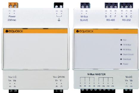
Level Converter M-Bus per gestione fino a 250 dispositivi. Modulo di campo stand-alone per lettura dati dai contatori M-Bus tramite porte RS232, RS485 (esclusive), Interfaccia M-Bus slave per utilizzo come ripetitore per estendere di ulteriori 250 dispositivi la rete M-Bus. Alimentazione 230V AC (alimentatore incluso).
