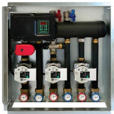
I **GRUPPI SOTTOCALDAIA** sono in grado di regolare in modo indipendente ciascuna zona termica rendendo l'impianto svincolato dal generatore grazie alla funzione integrata di separazione idraulica. Trovano applicazione in abbinamento a caldaie a gas, pompe di calore e caldaie a biomassa per il riscaldamento.
