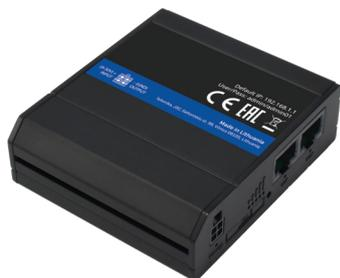
Router compatto 4G dotato di interfaccia Ethernet e Wireless. Il dispositivo fornisce una connettività Internet sicura e stabile per applicazioni che utilizzano il software RutOS e funzioni di sicurezza come OpenVPN, IPsec, Firewall, Hotspot, controllo SMS e supporto RMS. Alimentatore, antenna GSM, antenna Wi-Fi inclusi nella confezione.
