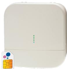
Concentratore di dati che consente l'acquisizione dei segnali provenienti da dispositivi wireless M-Bus, dotato di modem GPRS integrato. Può gestire fino a 200 dispositivi e diverse periodicità di trasmissione (settimanale, giornaliera, oraria, quattoraria). Fornito con SIM CARD integrata ed un anno di traffico dati con report settimanale. Il range di copertura può essere esteso tramite repeater unidirezionali MBWRPT.
