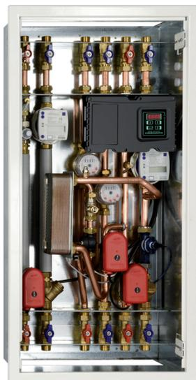
**LOWTHERM** è un Modulo Satellite di contabilizzazione diretta e gestione per impianti di riscaldamento e raffrescamento in alta e bassa temperatura con produzione centralizzata di acqua calda sanitaria. L'installazione prevista è ad incasso con cassa dima, le connessioni all'impianto sono contrapposte: superiori all'impianto centralizzato ed inferiori all'unità abitativa.
