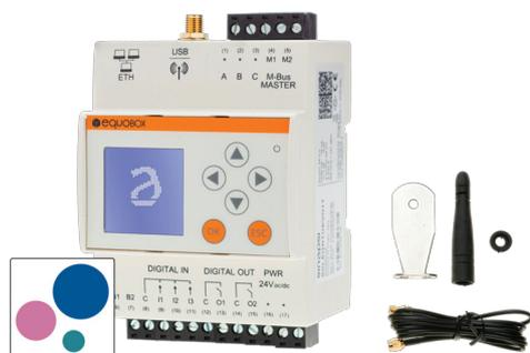
Datalogger M-Bus per gestione fino a 20 dispositivi cablati e 2.500 dispositivi wireless M-Bus con funzionalità Multi-Hop tramite concentratori. Lettura dati mediante interfaccia WEB. Display integrato per setup e lettura dati, espandibile fino a 250 contatori tramite moduli level converter. Alimentazione elettrica 24V AC/DC, consumo massimo 14,5W.
