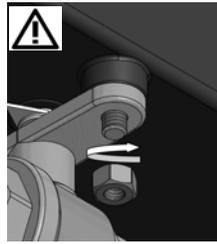
Per i modelli DIAMANT DC il dado di fissaggio al corpo valvola **non deve** essere serrato a più di **4 Nm**
