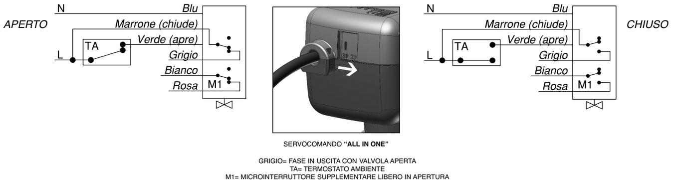
Le figure rappresentano lo schema elettrico del servocomando con comando a **2 PUNTI - ON/OFF**.
