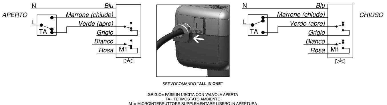
Le figure rappresentano lo schema elettrico del servocomando con comando a **3 PUNTI - ON/OFF**.
